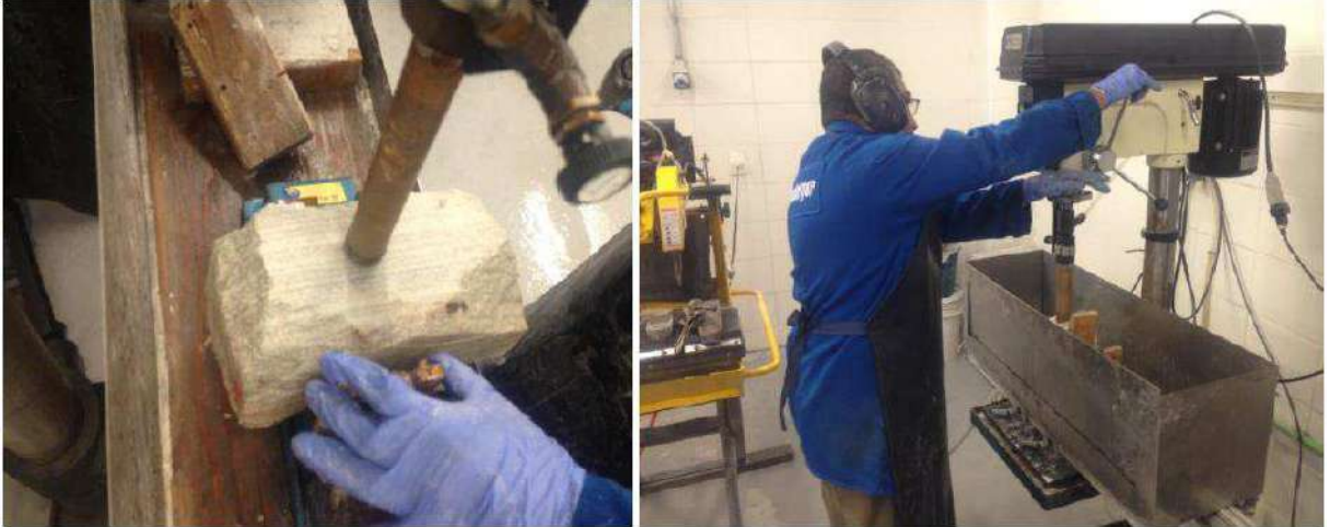
Figura 2.3: Processo para obtenção dos plugues, com broca de diâmetro interno de 1,5". (Câmara, 2013)
