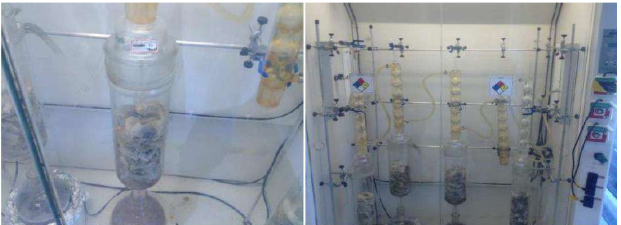
Figura 2.4: Lavagem dos plugues com tolueno e metanol. (Câmara, 2013)
