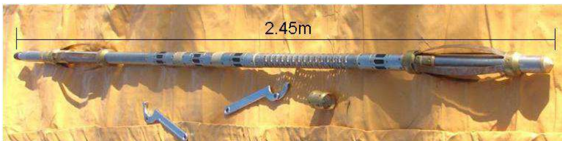
Figura 10 - Foto do perfilador sônico Slim-Hole Full-Waveform Triple Sonic Probe fabricado pela empresa Robertson Geologging Ltd. Fonte: Silva (2012)
