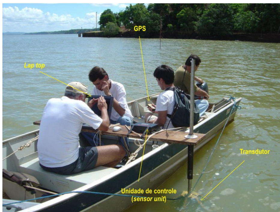
Figura 24 - Configuração dos equipamentos utilizados no levantamento sísmico no lago Juparanã.
