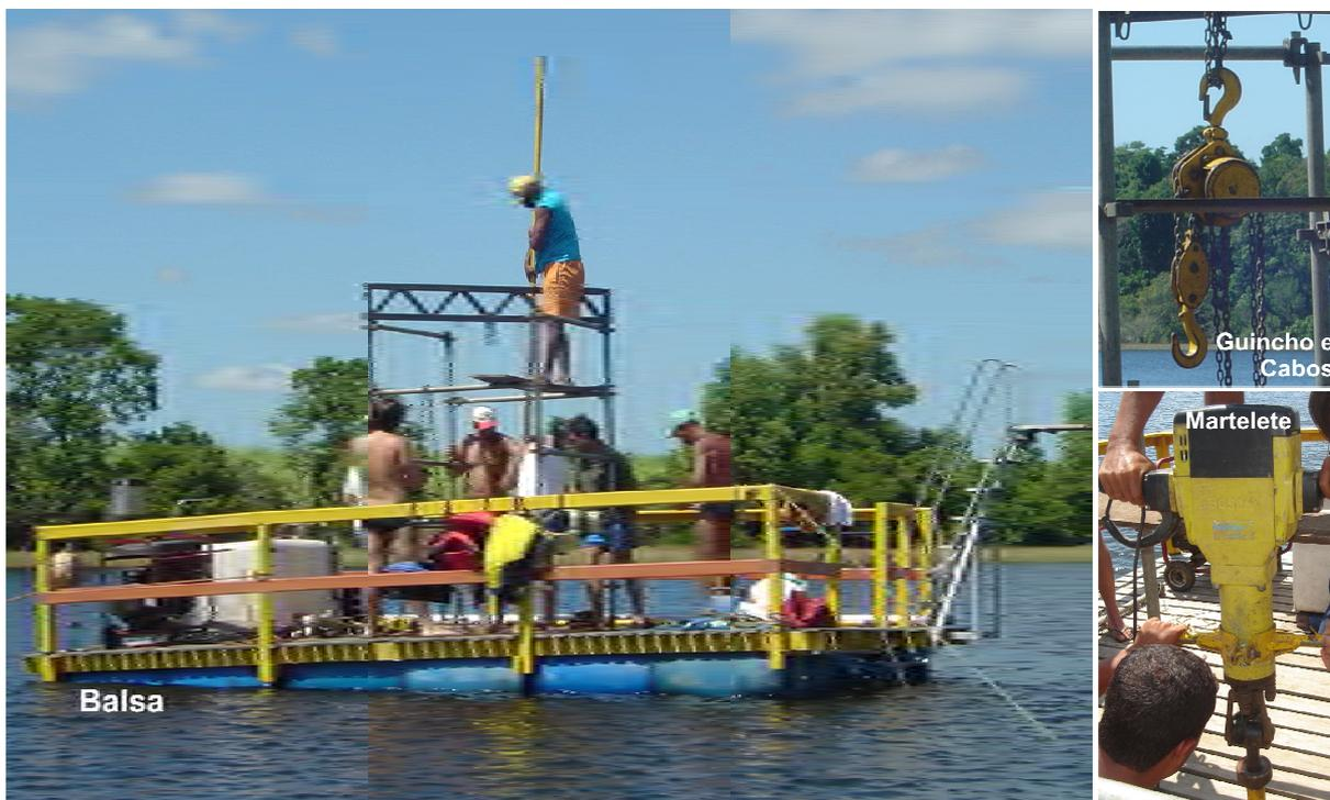
Figura 17 - Balsa e alguns equipamentos utilizados na realização das sondagens na lagoa Durão.
