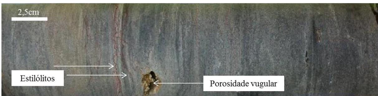
Figura 17 – Imagem de um plugue obtido em uma das bioermas da área. É possível observar laminação incipiente, com a ocorrência de estilólitos e porosidade vugular, indicadores de processos pós-deposicionais atuando no aumento da porosidade da rocha (Corbett *et al.*, 2014).
