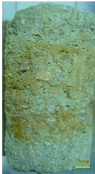
Figura 7 – Aspecto da litofácies Am, mostrando arenito grosso, cinza esverdeado, mal selecionado e maciço. (Prof. 49,25 m)
