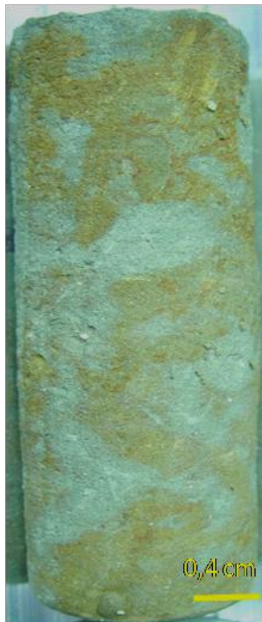
Figura 10 - Foto em detalhe da litofácies Pmm, mostrando um siltito arenoso, bem selecionado e com alta argilosidade. (Prof. 112,10 m)
