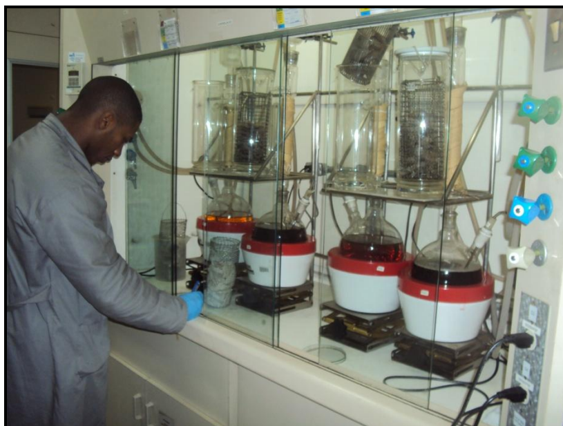
Figura 4.2.3 - Conjunto de extratores Soxhlet .
