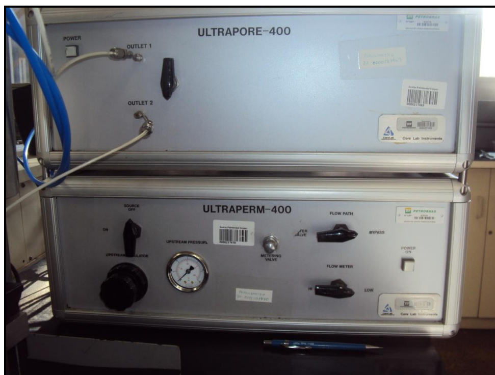
Figura 4.2.1 - Porosímetro e permeâmetro Corelab , modelos UltraPore 400 e UltraPerm 400 , respectivamente.
