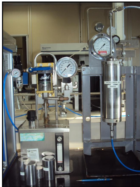
Figura 4.2.9 - Célula hidrostática para plugues de 1,5" a direita e bomba pressurizadora a esquerda.
