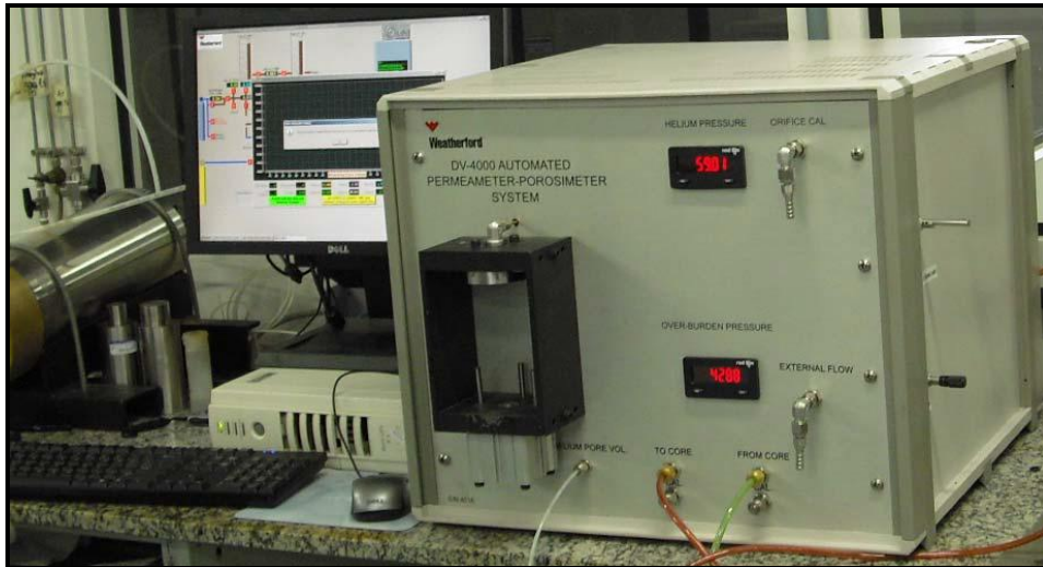
Figura 4.2.2 - Porosímetro/Permeâmetro Weatherford, modelo DV-4000.
