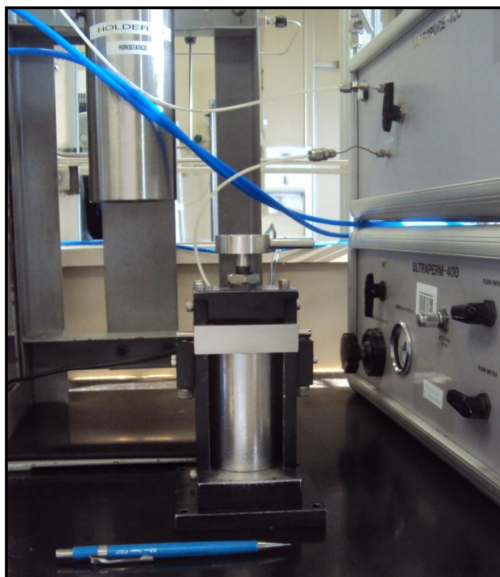
Figura 4.2.6 - Câmara externa conectada com o porosímetro.
