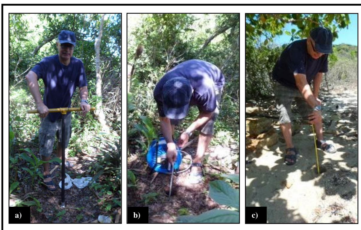
Figura 13: Fotos da execução dos furos a trado feito na área de estudo e das medidas de nível d'água. Legenda: (a) Furo a trado na área do manguezal; (b). Medição do nível d'água com medidor automático; (c). Medição do nível d'água com trena portátil.
