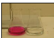
Figura 1: Titulação com fenolftaleína: (a) antes da titulação, (b) após viragem de cor.
