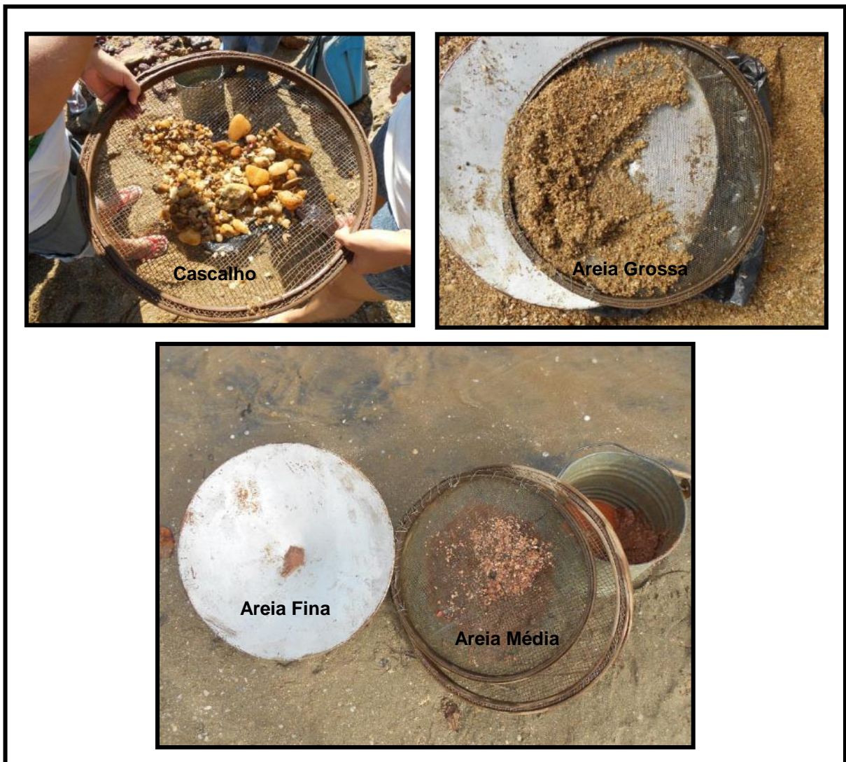
Figura 42: Peneiramento realizado em campo com amostra do conglomerado – Mangue de Pedra – Armação dos Búzios – RJ.
