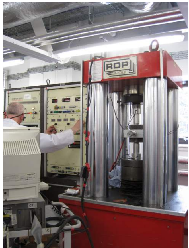
Figura 22 – Célula triaxial e dispositivos de monitoramento (Foto: Helen Lewis)
