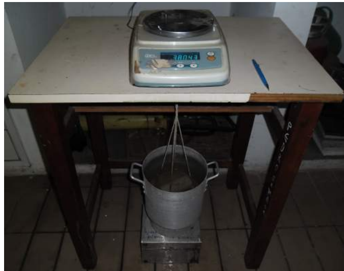
Figura 17 – Medição de massa saturada submersa, pelo método de empuxo, de plugs da amostra 3.
