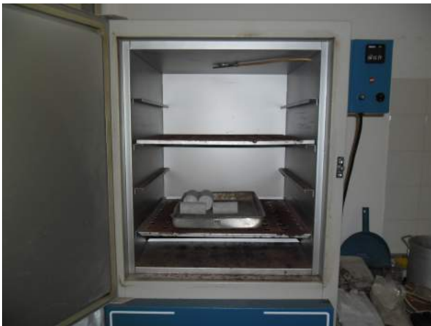
(a) Secagem em estufa a 105^{\circ}\text{C} , por 24h.
