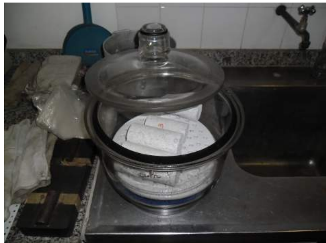
(b) Resfriamento isento de umidade por 1h.
