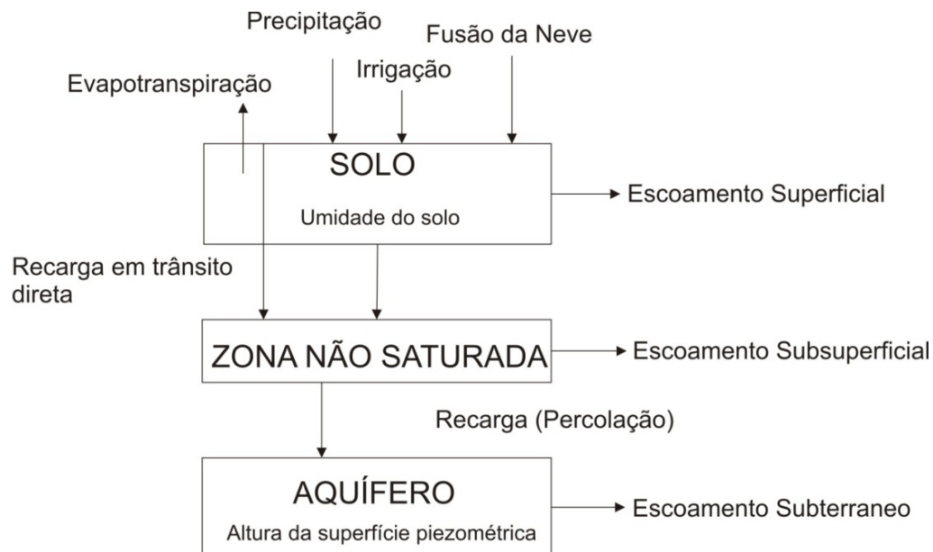
Figura 12 - Esquema hidrológico adotado pelo Visual Balan (adaptado de SAMPER et al., 1999).
