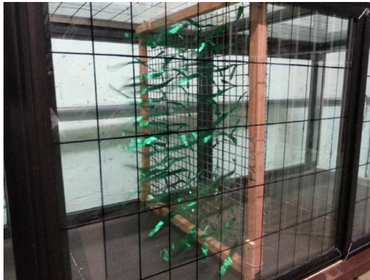
Figura 49. Teste de visualização do escoamento de ar dentro do túnel de vento usando grade com fitilhos. Foto da autora.
