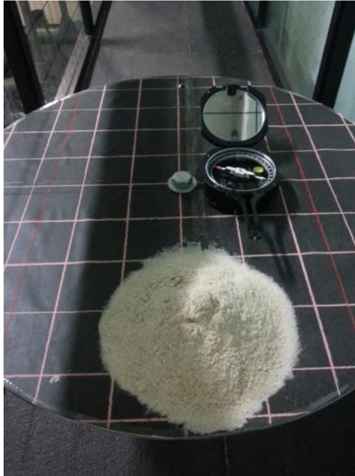
Figura 61. Prato da Plataforma Móvel, cone inicial de areia e bússola para ajustar a inclinação da superfície do prato. Foto da autora.
