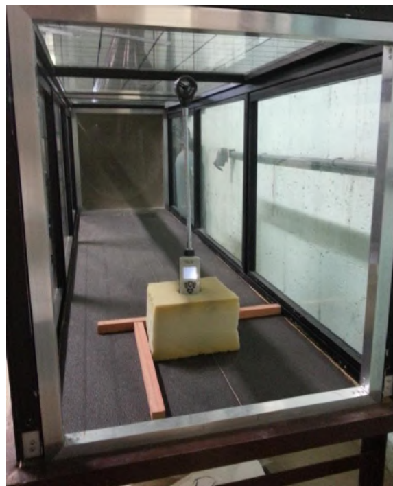
Figura 47. Anemômetro usado para medir as velocidades e temperaturas dentro do túnel de vento durante os ensaios. Foto da autora.
