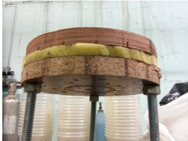
Figura 59. Topo do suporte: peças de madeira separadas por espuma de estofado. Foto da autora.
