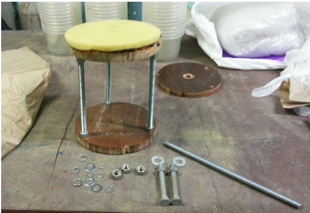
Figura 58. Suporte para o prato: topo, base, pilares, parafusos, porcas, arruelas e barra roscada. Foto da autora.
