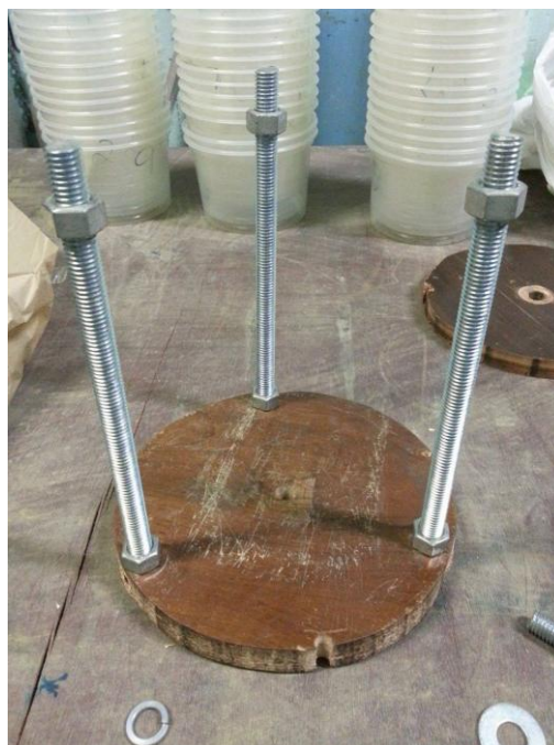
Figura 60. Base do suporte e pilares com porcas. Foto da autora.
