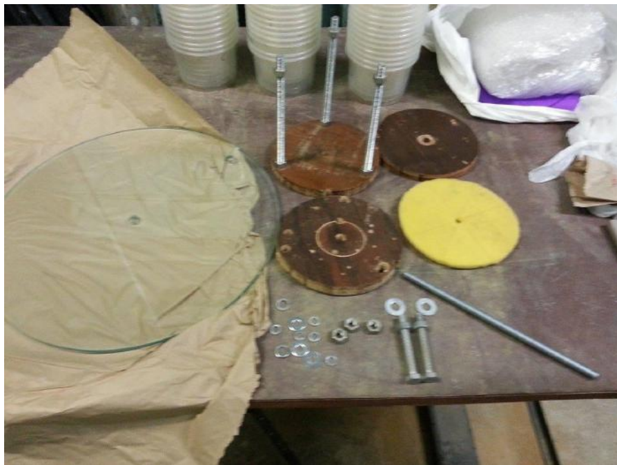
Figura 55. Material usado para construção da Plataforma Móvel. Foto da autora.
