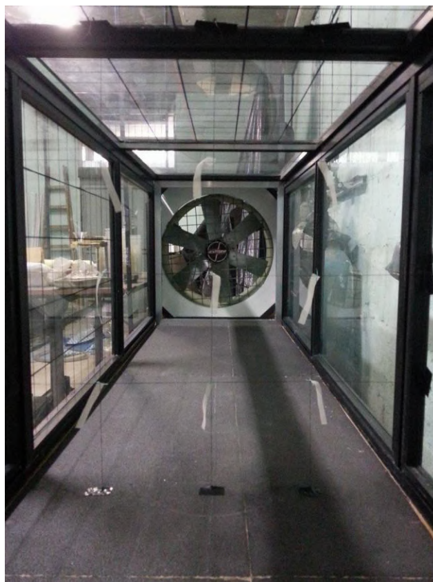
Figura 74. Foto da seção interna do túnel e o método de grade com fitilhos. Foto da autora.
