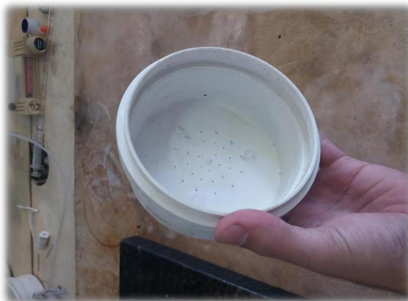
**Figura 15 - Base do reator, dotada de furos para passagem da corrente gasosa**
