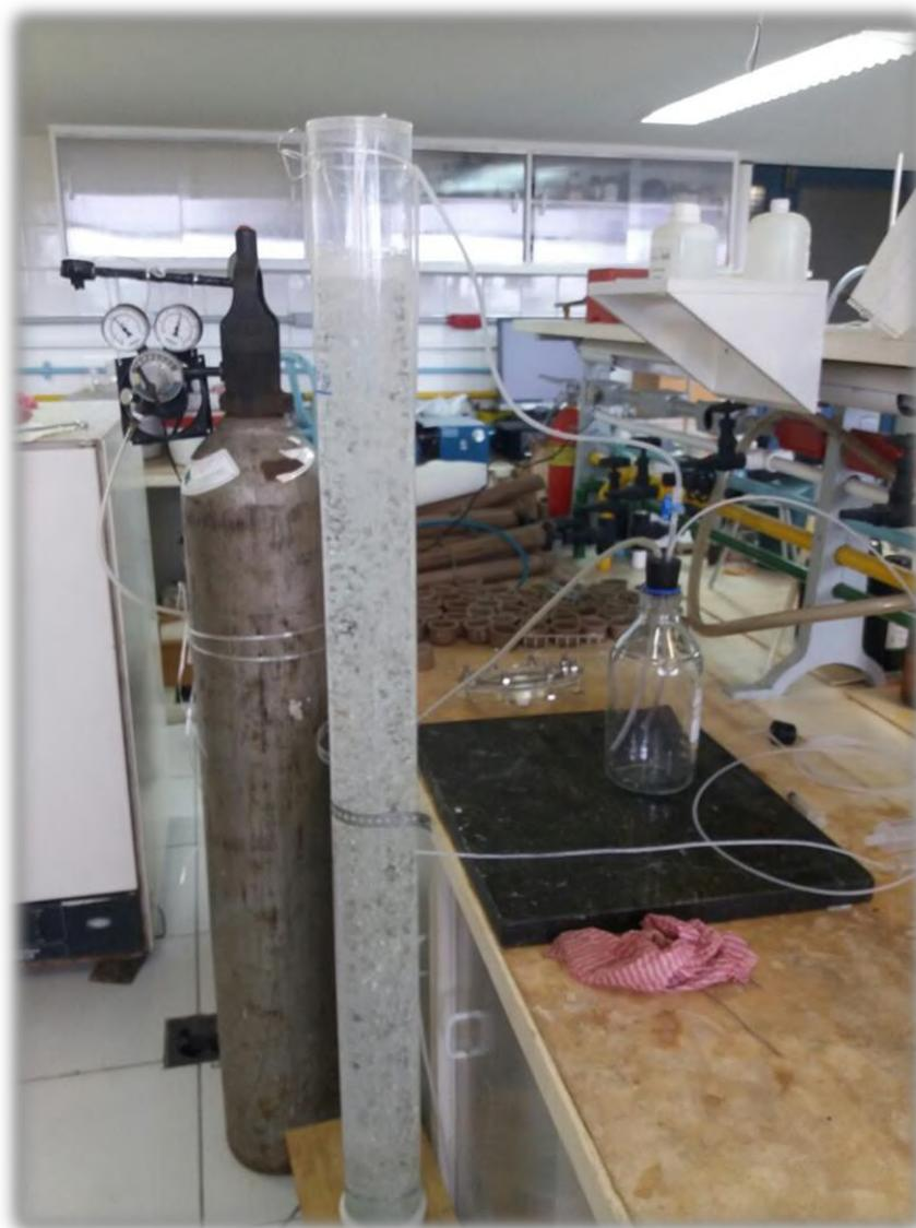
**Figura 16 - Reator para absorção de CO<sub>2</sub> em funcionamento**
