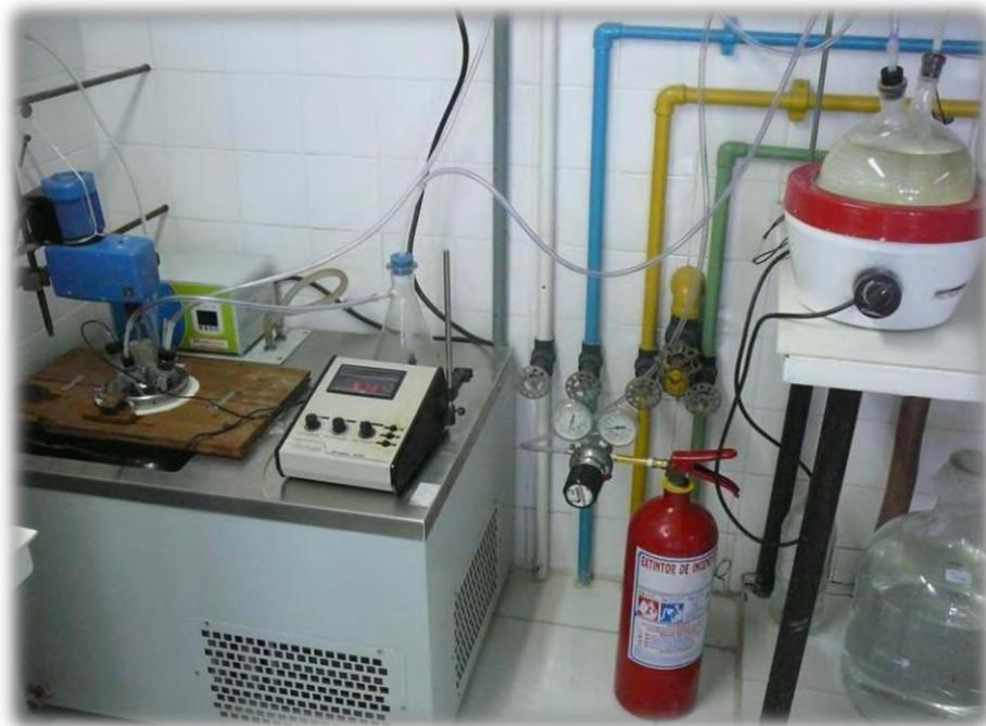
**Figura 10 – Reator principal em banho refrigerado. Produção de  $\text{NH}_3$  à partir de  $\text{NH}_4\text{Cl}$**
