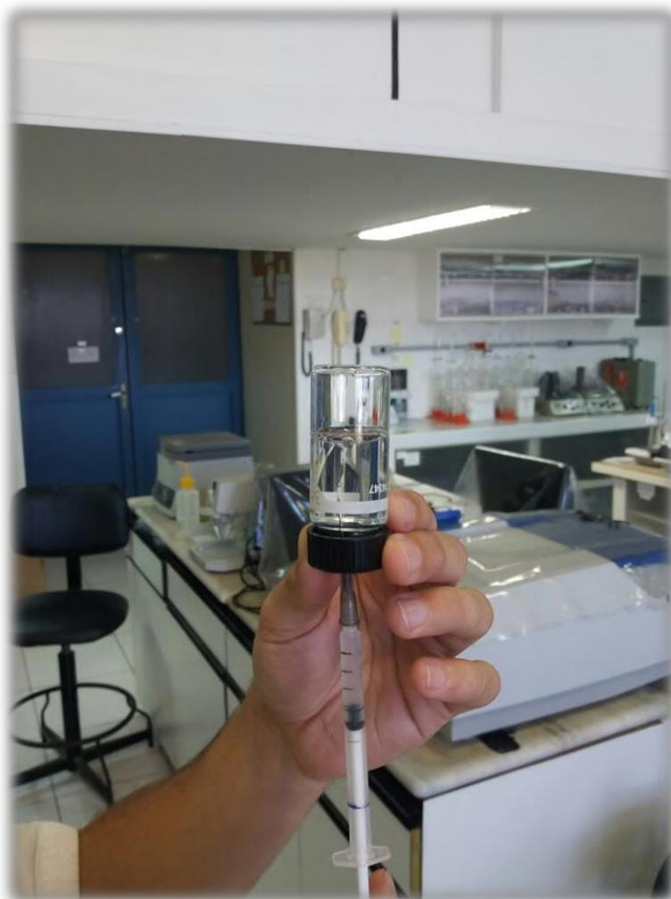
**Figura 27 - Adição da mistura gasosa para reação com  $\text{Ba}(\text{OH})_2$**
