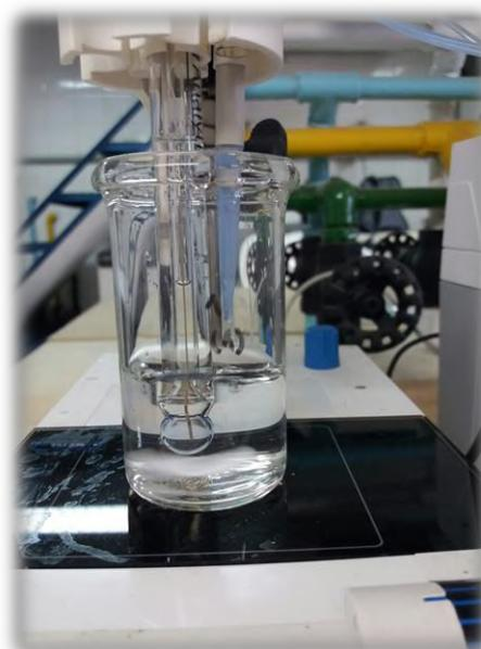
**Figura 33 - Recobrimento da junção do eletrodo combinado de vidro**
