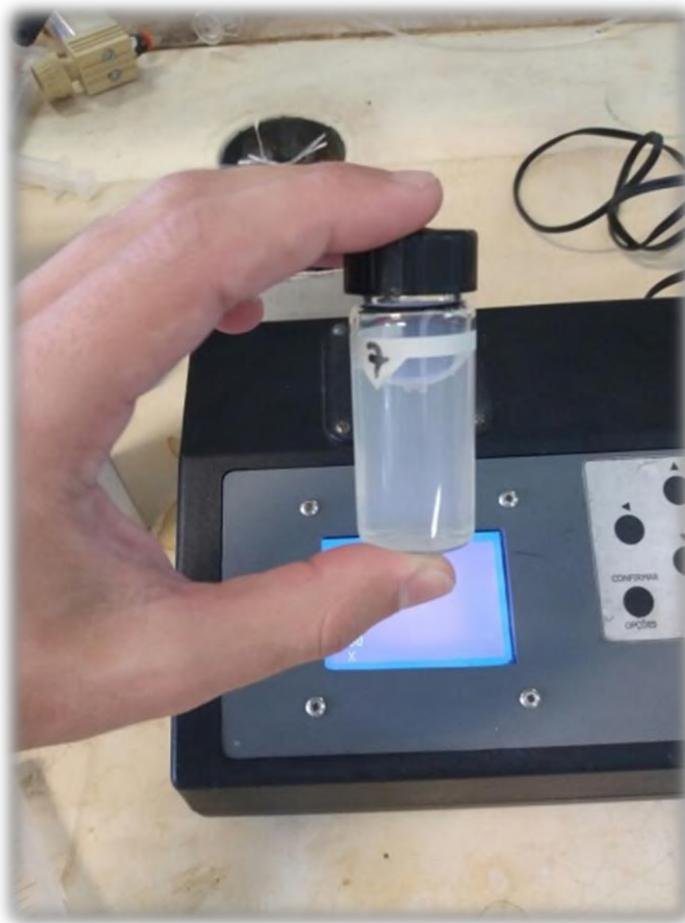
**Figura 23 – Formação da Turbidez  $(\text{BaCO}_3)_{(s)}$**
