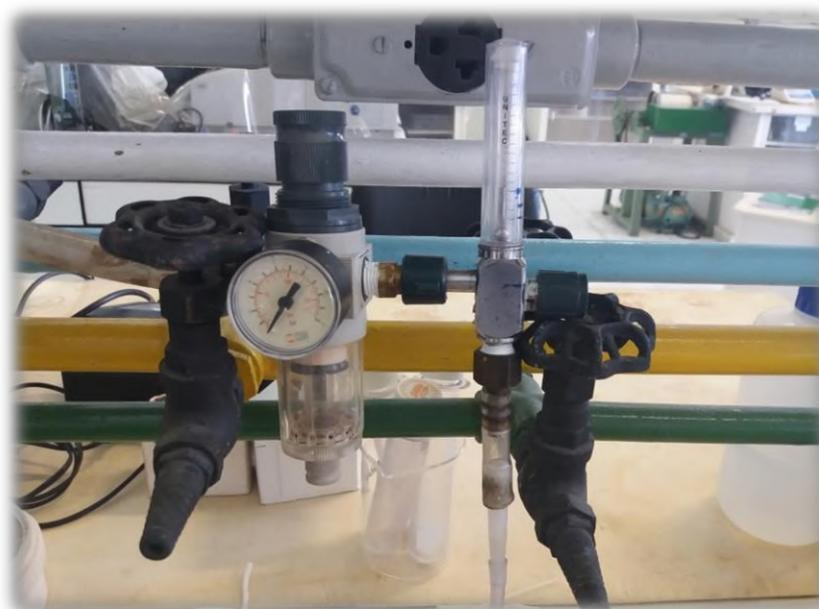
**Figura 20 – Flow meter de controle do ar comprimido**
