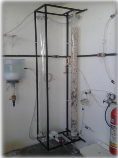
**Figura 13 - Reator tubular. Produção de  $\text{NaHCO}_3$  grau microalga**
