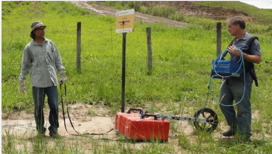
Figura 8: Aparelho de GPR utilizado no presente estudo.
