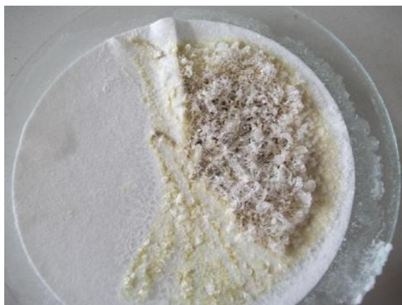
Figura 13. Resíduo de \text{Al}(\text{OH})_3 e \text{NH}_4\text{VO}_3
