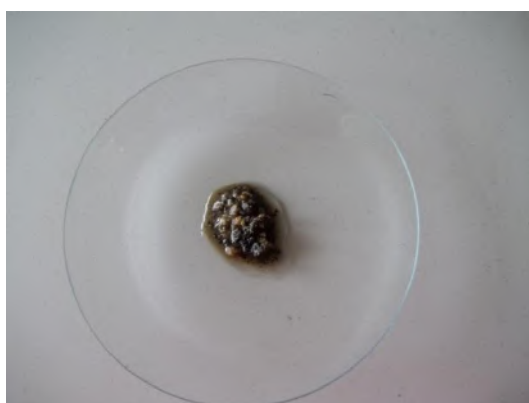
Figura 3. Aspecto do catalisador 3, que contém W, Mo, Si, V e Ni
