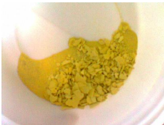
Figura 10. \text{WO}_3 \cdot \text{H}_2\text{O} após purificação do precipitado bruto do catalisador 1
