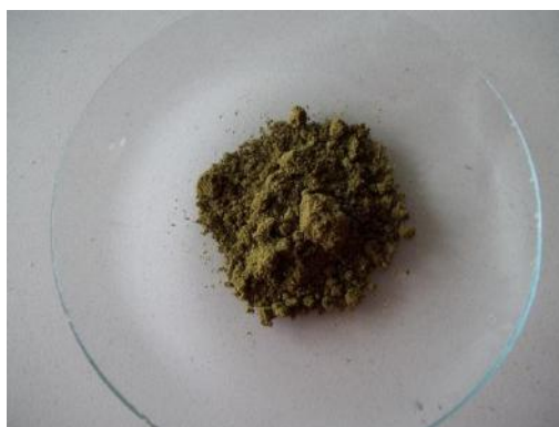
Figura 2. Aspecto do catalisador 2, que contém W, Mo, Ni, Al e V
