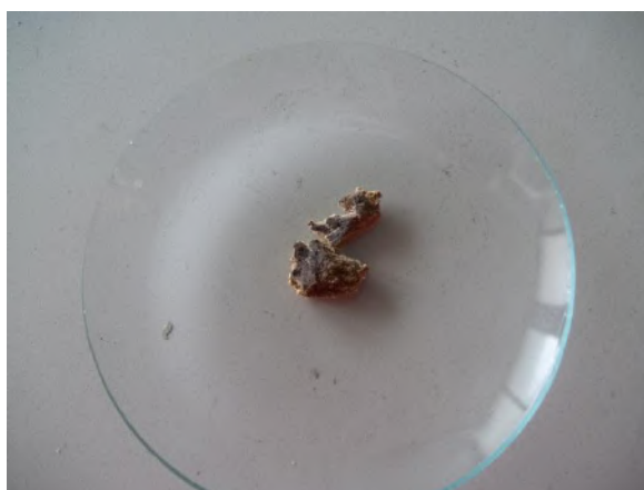
Figura 15. Precipitado de \text{VO}(\text{OH})_2
