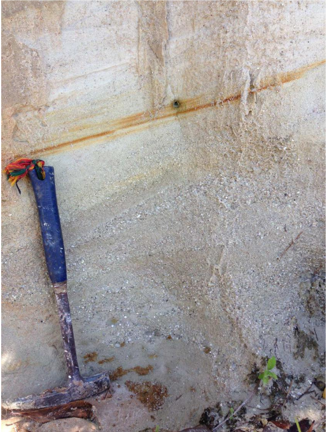
Figura 33: Litofácies Ah1 e Litofácies Aa. Essas litofácies quase sempre são notadas ao longo de perfis com mais de 3 metros nas sucessões areníticas da Formação Resende ss e Floriano. Ponto localizado na via Dutra, km 308.
