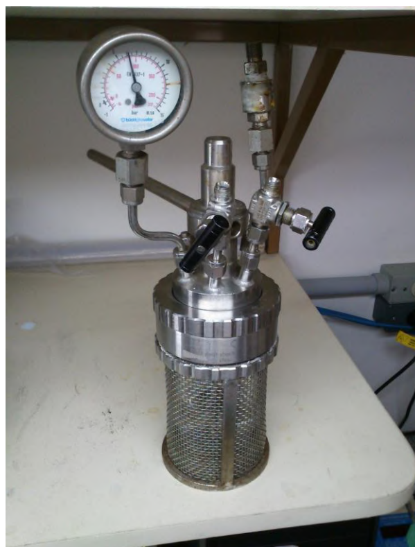
Figura 8: Sistema autoclave pressurizado a 5 bar
