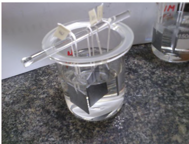
Figura 6: Sistema montado para ensaio de perda de massa à temperatura ambiente, em meio de HCl 1M
