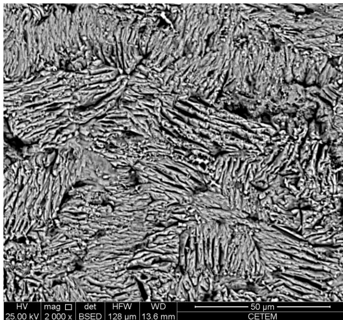
Figura 29: Superfície do aço-carbono 1020 submetido ao ensaio de perda de massa em solução de HCl 1M na ausência do inibidor
