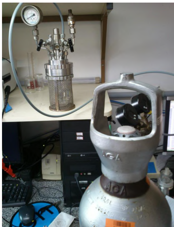
Figura 7: Borbulhamento do sistema com CO 2 para troca de atmosfera
