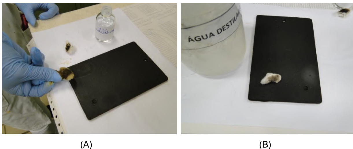
Figura 5.11 - Teste de solubilidade para tinta epóxi alcatrão de hulha e identificação de gizamento em sua superfície. Em (A) teste aos solventes MEC e tolueno. Em (B), confirmação da presença de gizamento da tinta, usando água destilada.
