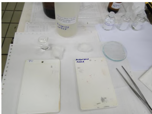
Figura 4.7 - Materiais e reagentes utilizados no teste de resistência química ao meio alcalino.
