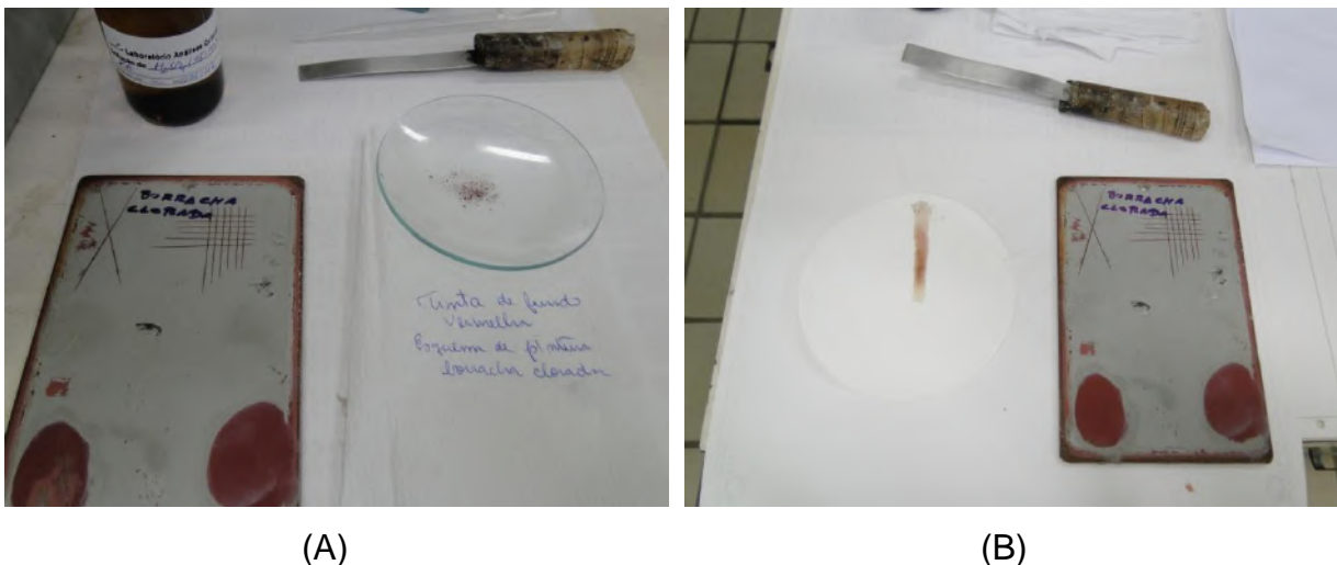
Figura 5.8 - Ensaio complementares para testar películas de tinta com H_2SO_4 concentrado. Em (A) tinta de fundo para esquema com borracha clorada para a tinta de acabamento. Em (B) teste falso positivo com H_2SO_4 concentrado.
