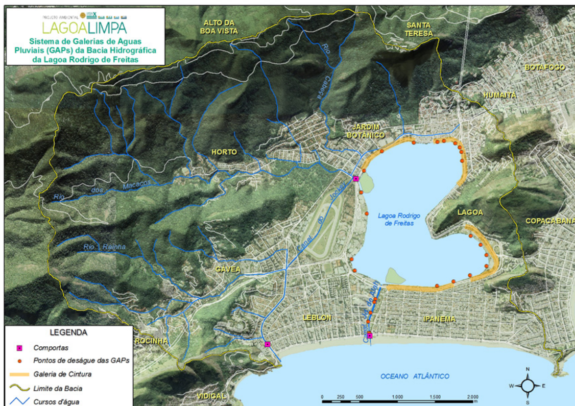
Figura 12: identificação de exutórios de sistemas de drenagem ao redor da Lagoa e de galerias de cintura (fonte: Projeto Lagoa Limpa [19])
