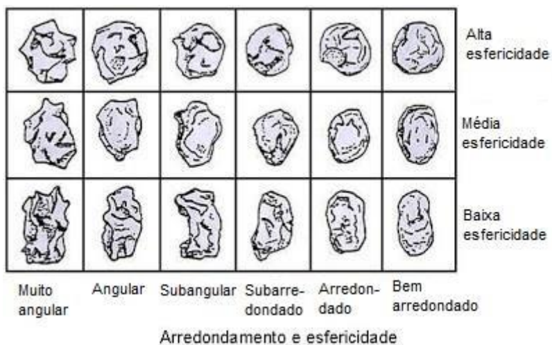
Figura 2.5 Escala de arredondamento x esfericidade [8].
