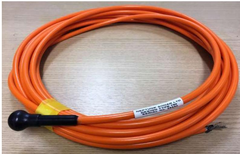
Figura 3.25: Hidrofone T50 S/N 28550, da Neptune Sonar.
