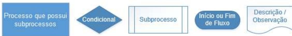
Figura 3.19: Tipos de blocos do fluxograma.
