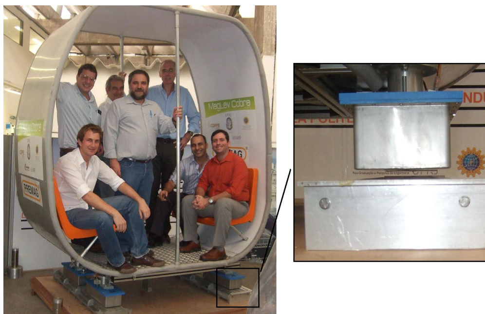
Figura 7: Protótipo em escala real do veículo supercondutor. A figura a direita mostra com detalhes um dos criostatos sobre o trilho magnético.
