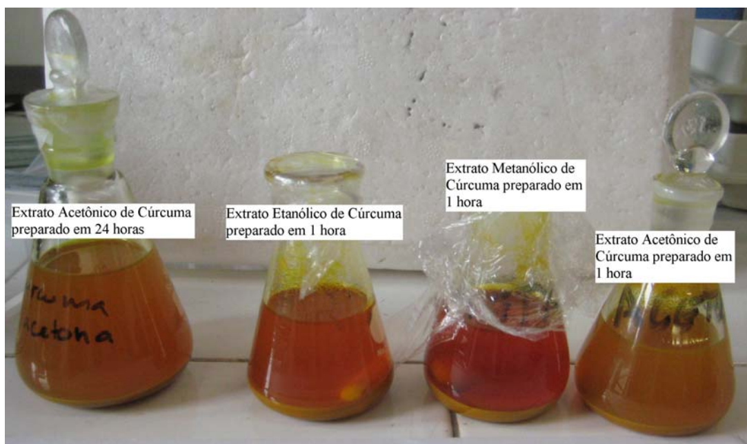
Figura 4.1 – Fotografia dos extratos de cúrcuma preparados no laboratório. O primeiro extrato foi preparado com acetona agitando por 24 horas. O segundo extrato foi preparado com etanol 95 % no agitador magnético por 1 hora. O terceiro extrato foi preparado com metanol agitado por 1 hora e por último foi preparado outro extrato de acetona agitado por uma hora.
