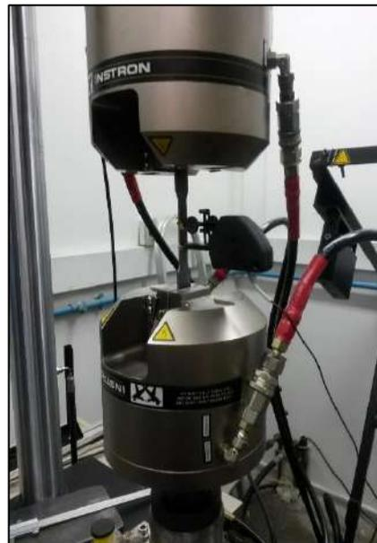
Figura 3-48 - Vista 2 do corpo de prova instrumentado com extensômetro mecânico e acoplado a Instron® 8802.
