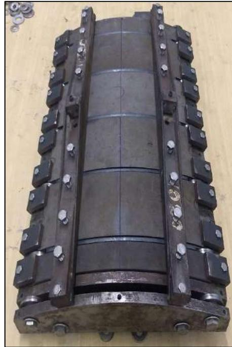
Figura 3-8 Painel pronto para ser montado com dispositivo para evitar empenamento.
