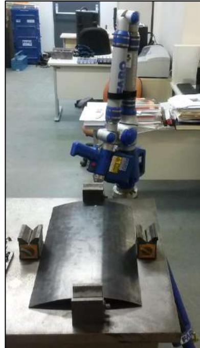
Figura 3-15 Conjunto de aparatos para varredura FARO<sup>®</sup>.
