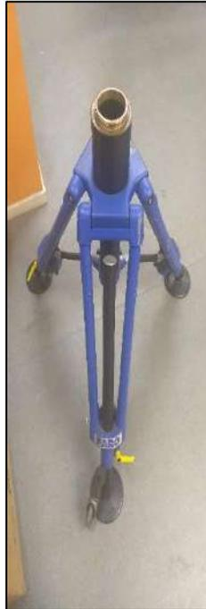
Figura 3-14 Tripé de apoio FARO<sup>®</sup>.
