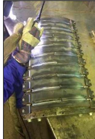
*Figura 3-10 Esquema de alternância dos cordões de solda.*
