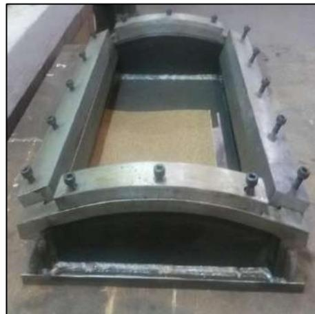
Figura 3-4 - Vista 2 do Berço com os grampos de fixação.
