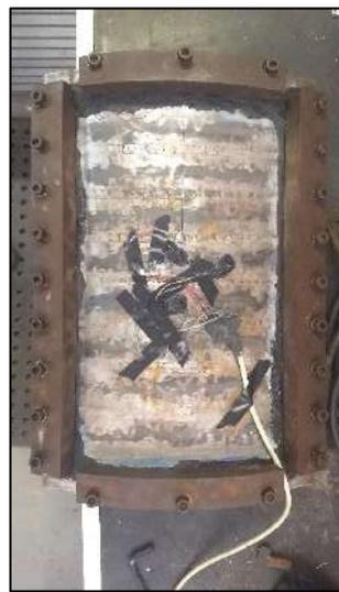
Figura 3-68 Painel instrumentado com extensômetros elétricos com aplicação de resina isolante.
