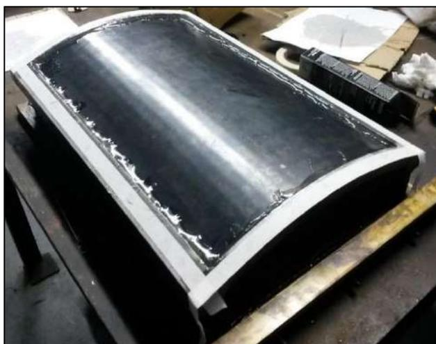
Figura 3-63 Aplicação da resina *5 Minute™ Epoxy*.
