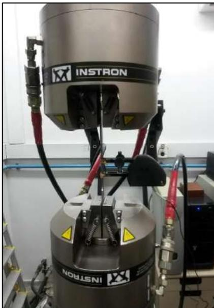
Figura 3-47 - Vista 1 do corpo de prova instrumentado com extensômetro mecânico e acoplado a Instron® 8802.
