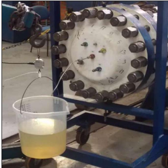
Figura 3-69 Célula de carga, recipiente de retenção e conectores externos.
