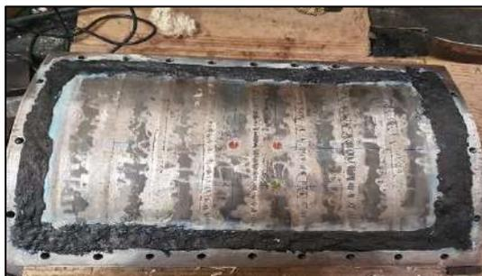
*Figura 3-65 Vedação com massa plástica adesiva e borracha vulcanizada.*
