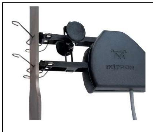
Figura 3-42 Extensômetro mecânico clip-on gauge.
