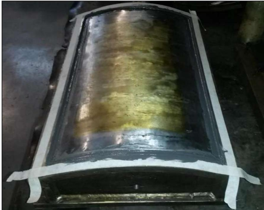
*Figura 3-64 Aplicação da resina Plastic Steel Putty.*
