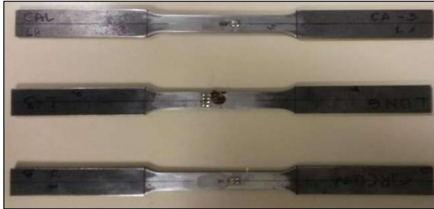
Figura 3-46 Corpos de prova instrumentados com os extensômetros elétricos.
