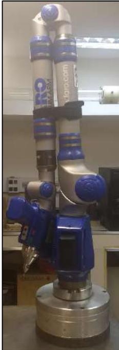
Figura 3-13 Braço de varredura FARO<sup>®</sup>.
