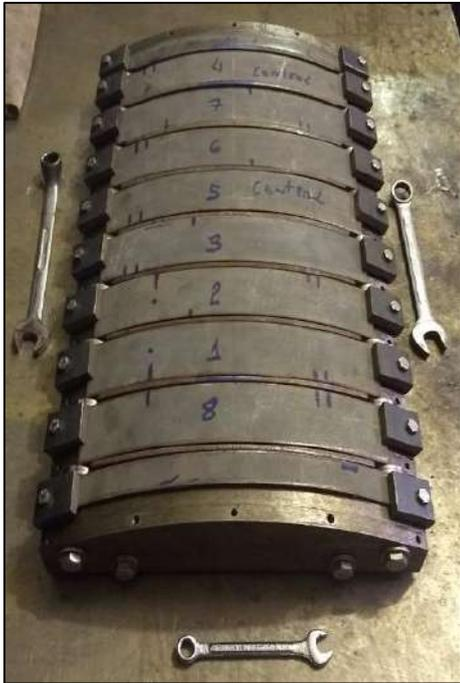
Figura 3-7 Painel montado pronto para a soldagem.
