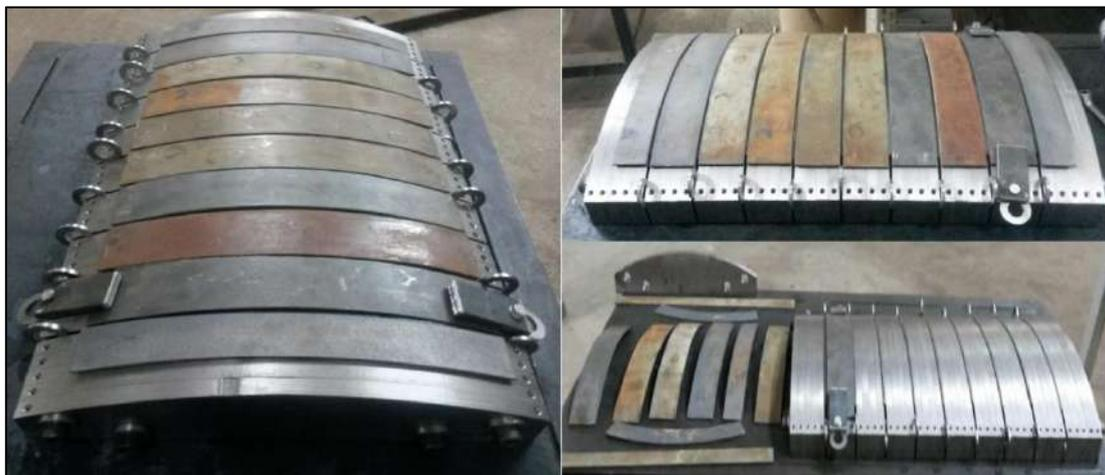
*Figura 3-6 - Gabarito de solda com as cascas cilíndricas componentes e cavernas posicionadas.*
