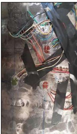
Figura 3-67 Detalhe dos extensômetros elétricos.
