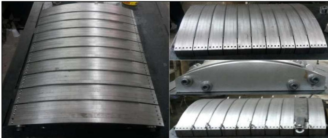
*Figura 3-5- Gabarito de solda dos painéis composto de fatias e aparatos de fixação.*
