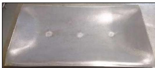
Figura 3-79 Painel sem reforço 2 colapsado.
