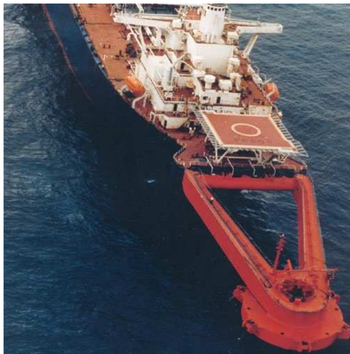
Figura 20 - Navio utilizando sistema CALM com ligação por meio de estrutura fixa
