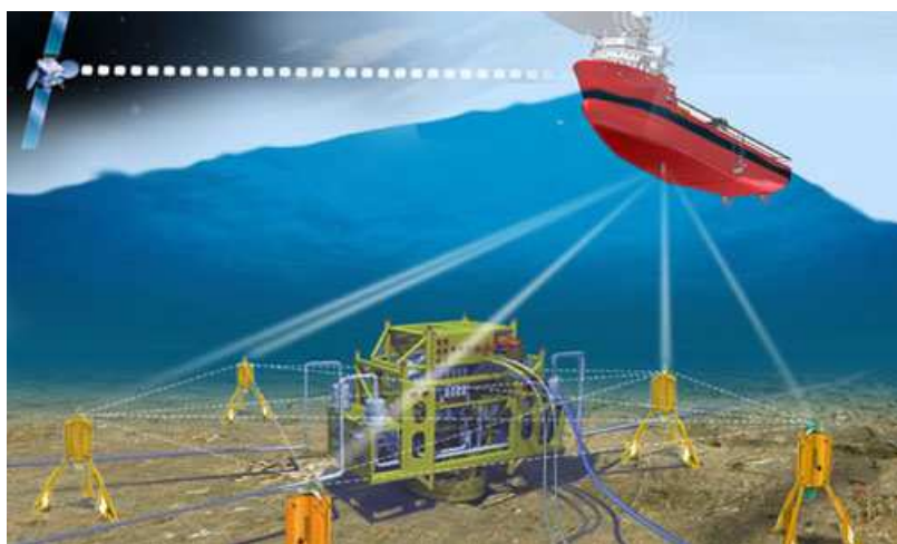
Figura 26 - Sistema de ancoragem com posicionamento dinâmico
