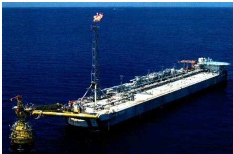
Figura 23 - Navio utilizando o sistema SALM
