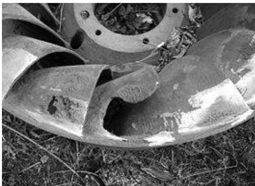
Figura I.1: Pás de uma turbina inutilizadas pela ação da cavitação.
