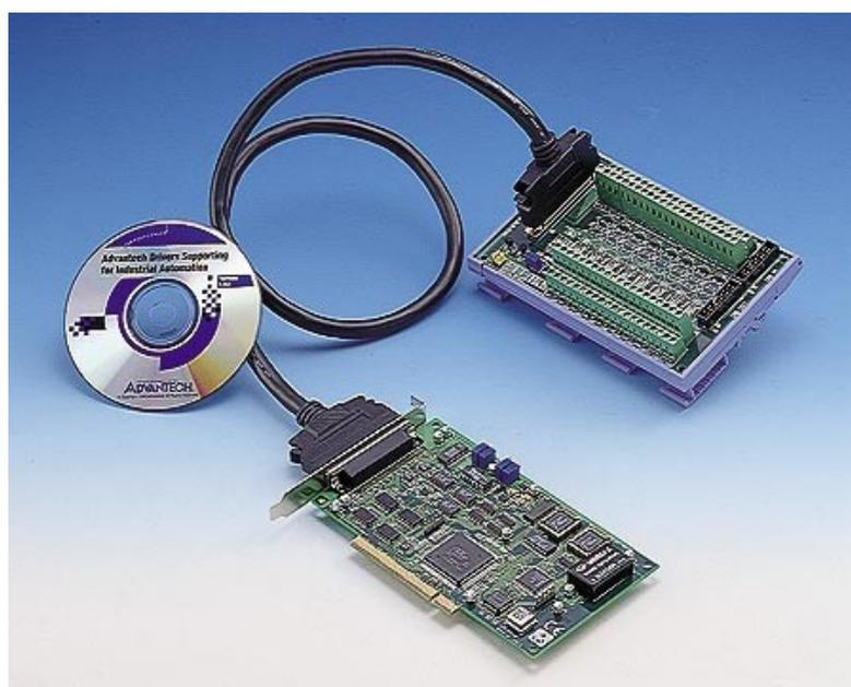
Figura 3.4 – Placa de aquisição de sinais utilizada
