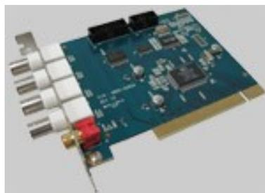
Figura 8: Placa de captura PCI.
