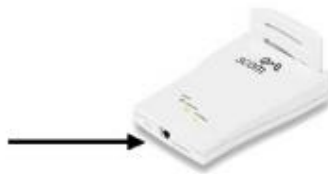
fig. 2.3 - Ponto de acesso com conector RJ-45.
