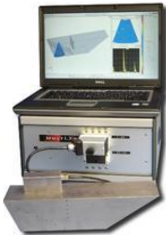
Fig. 24. Equipamento M2M MultiX++ utilizado no ensaio por ultra-som phased array.
