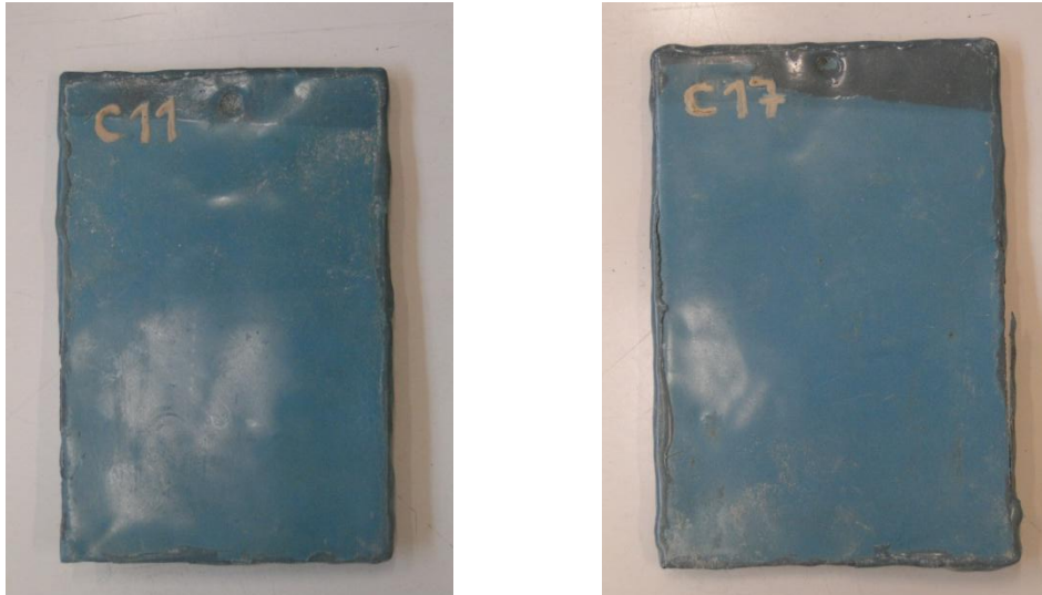
Fig. 18. Amostras provenientes de ensaios de imersão em ácido sulfúrico, substrato metálico consumido por corrosão devido a uma falha de borda e o revestimento permaneceu íntegro.
