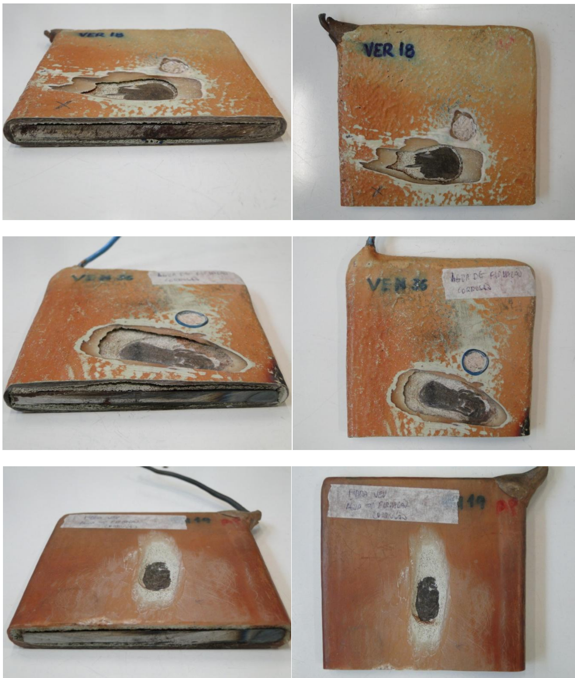
Fig. 19. Amostras provenientes de ensaios de imersão em água de formação, substrato metálico corroído e perda de aderência.
