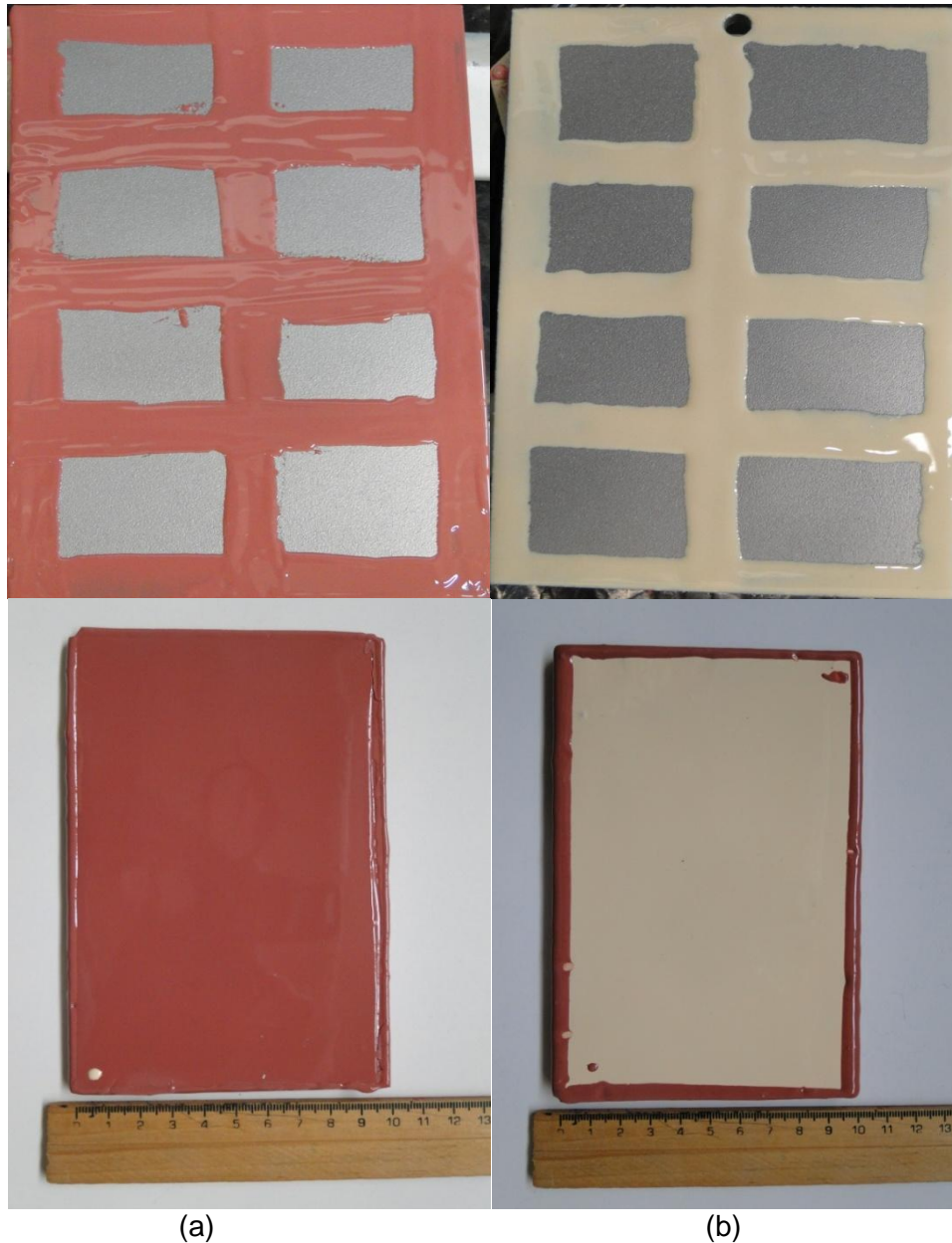
Fig. 22. Amostras revestidas com o revestimento A (a) e com o revestimento B (b), simulando falha de aderência entre o substrato e o revestimento.
