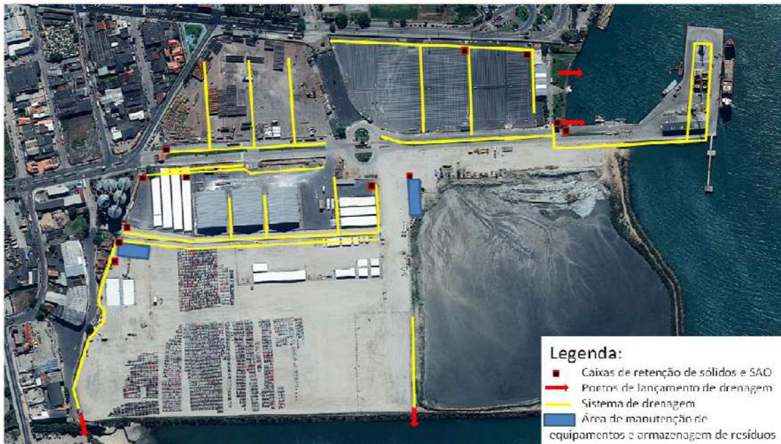
Figura 3-7: Sistema de drenagem pluvial do Porto de São Sebastião (Fonte: (CDSS, 2015)).
