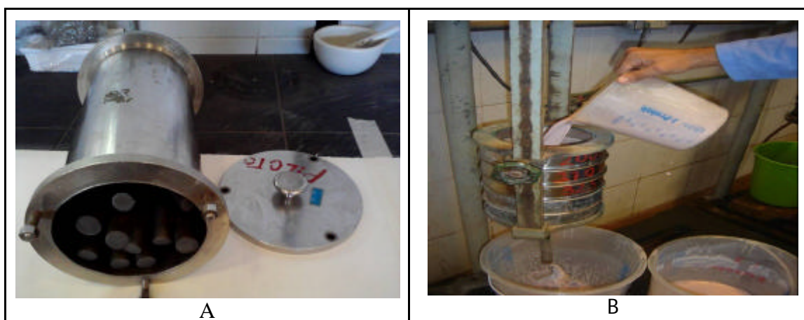
Figura 4. Em A, moinho de barras de laboratório e, em B, peneirador vibratório, ambos utilizados na preparação da amostra.
