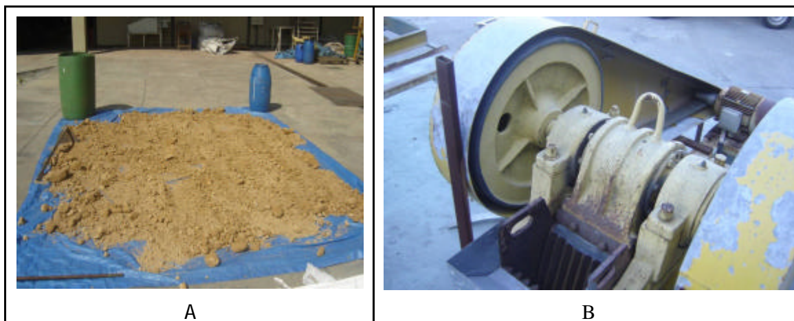
Figura 1. Em A, amostra de rocha potássica enviada ao CETEM para estudo. Em B, detalhes do britador de mandíbulas utilizado na preparação da amostra.
