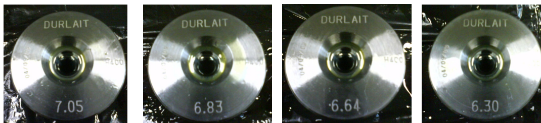
Figura 3.4: Fieiras utilizadas para a trefilação dos fios.
