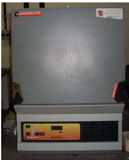
Figura 3.6: Forno Carbolite CWF 13/23 usado no tratamento térmico de envelhecimento.
