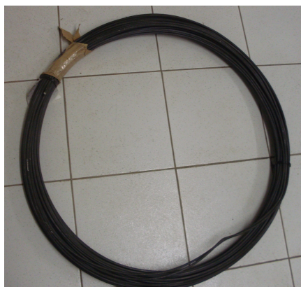
Figura 3.2: Fio-máquina laminado da superliga X-750 de 7,94mm de diâmetro.
