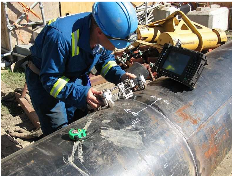
Figura 32 - Funcionário teste a solda realizada em uma tubulação metálica com um scanner ultrassônico. (Fonte: Wikipedia, visitado em 29/04/2011)
