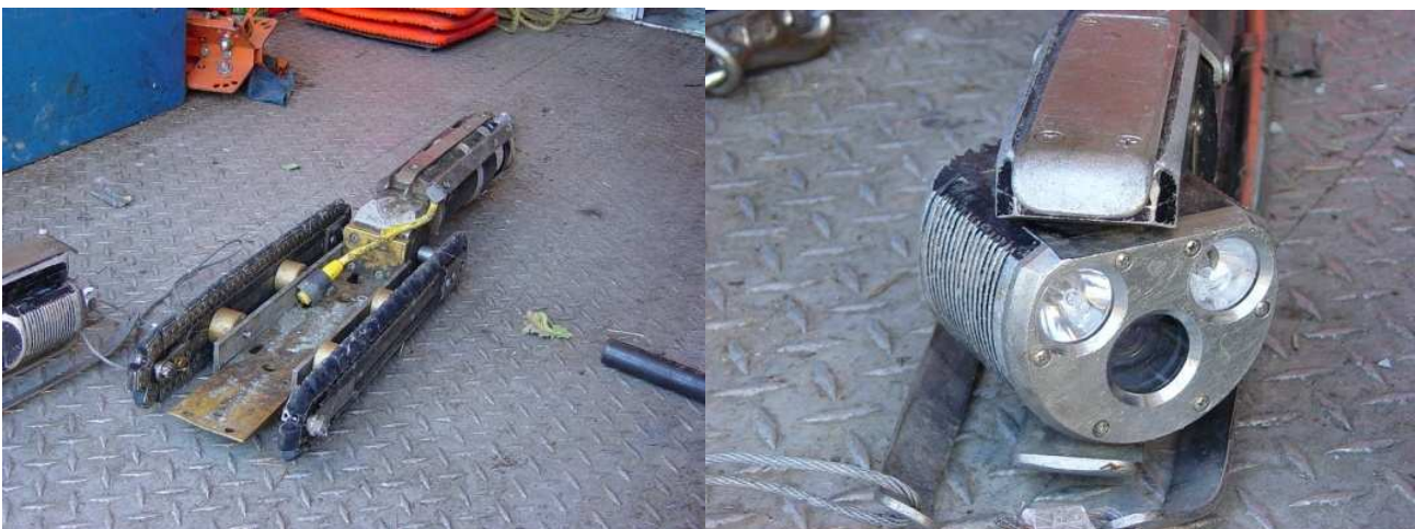
Figura 29 - Robô utilizado para a inspeção visual interna. No detalhe, a "cabeça" do robô, onde ficam posicionadas as luzes e a câmera. (Fonte: Wikipedia, visitado em 29/04/2011)
