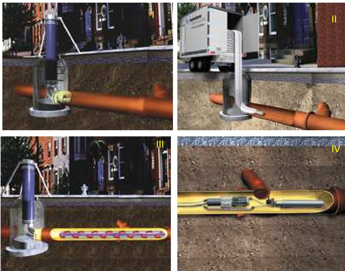
Figura 34 - I – A tubulação saturada de resina é empurrada ou puxada II. III – água quente ou vapor d'água é usada para curar a resina, formando um tubo sem juntas. IV – chegadas de outras tubulações na tubulação restaurada são abertas com a ajuda de ferramentas de corte controladas remotamente. (Fonte: http://www.insituform.com/content/190/how-insituform-cioo-is-installed.aspx )
