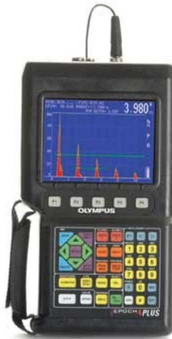
Figura 4.V – Aparelho de ultrassom utilizado na inspeção manual
