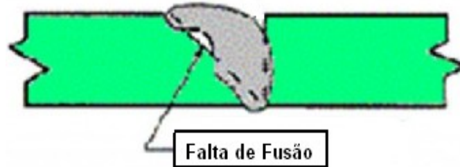
Figura 3.V – Falta de fusão
