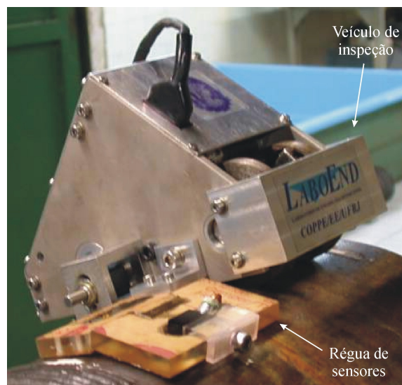
Figura 4.IV - Veículo de inspeção de ultrassom automatizado
