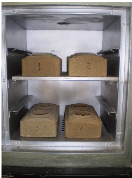
Figura 8: Tijolos secos em estufa a 105°C até constância de peso.
