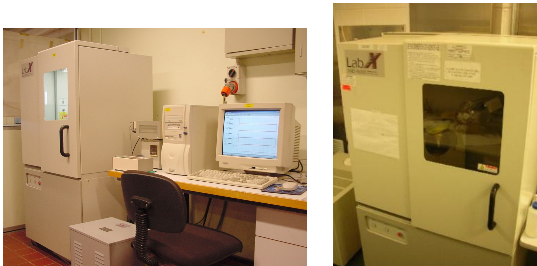
Figura 4: Difratômetro Shimadzu – modelo XRD 6000 – Laboratório de Difração de Raios-X do Departamento de Engenharia Metalúrgica e de Materiais da UFRJ
