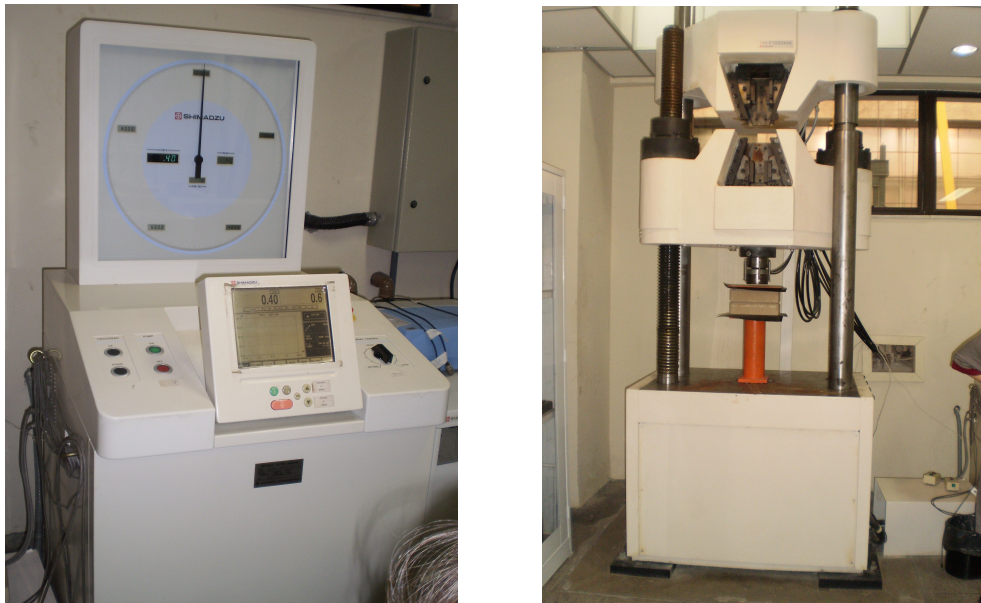
Figura 6: Prensa utilizada no ensaio de compressão simples.
