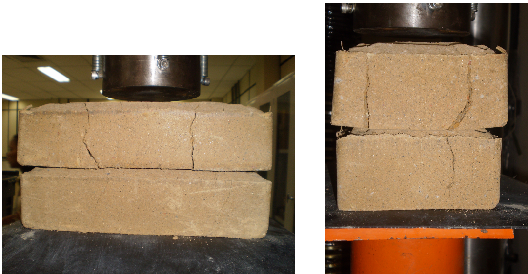
Figura 17: Tijolos após ensaio de compressão simples (vista frontal e lateral).
