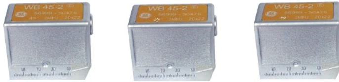
Figura 3.5 – Transdutores de 45°, 60° e 70° com freqüência de 2MHz.
