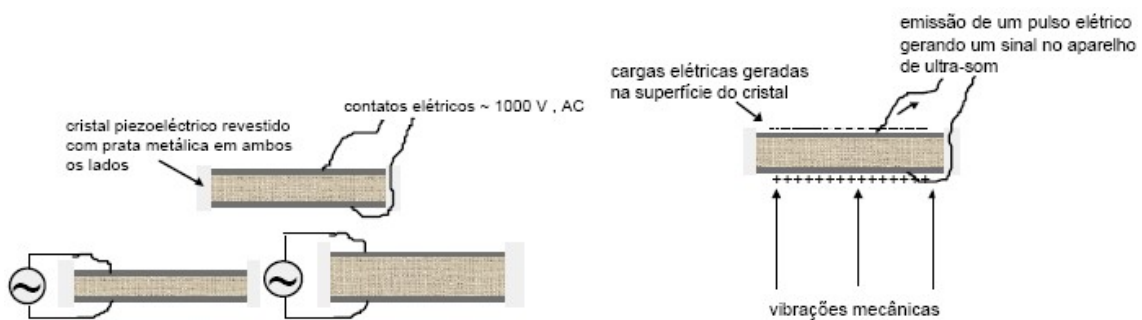
Figura 2.2. Contração e expansão do cristal quando submetido a uma alta tensão alternada na mesma frequência ultra-sônica emitida pelo cristal [3].
