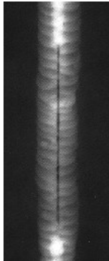
Figura 2.17. Radiografia mostrando falta de penetração [18].
