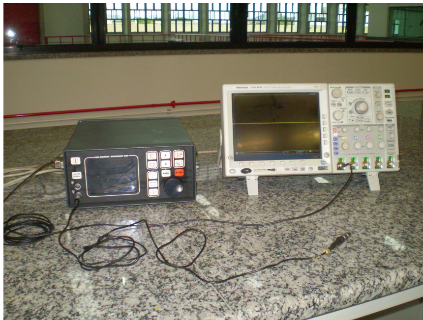
Figura 3.16 – Equipamentos utilizados no ensaio, ao lado esquerdo o aparelho de Ultra-som e do lado esquerdo o Osciloscópio.
