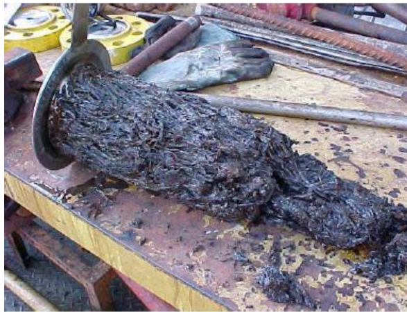
Figura 2 – Incrustação de naftenatos de cálcio (Goldszal, 2002).
