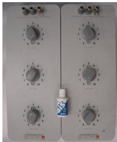
Figura 16 – Par de décadas de capacitores
