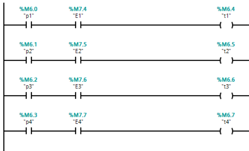
Figura 25 – Módulo de condições para o disparo das transições – sistema de acionamento de uma lâmpada.
