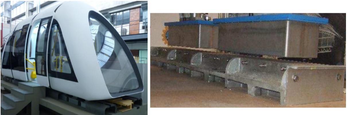
Figura 7. Foto do veículo MagLev Cobra e detalhe do mancal magnético supercondutor linear.
