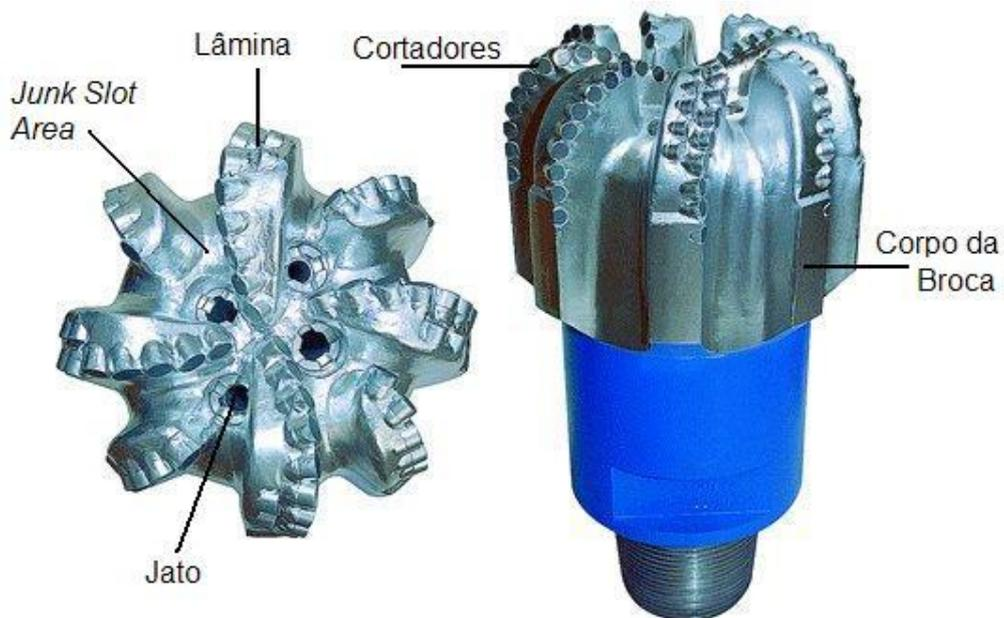
Figura 29 - Broca PDC de 8 lâminas **(HIMFR)**
