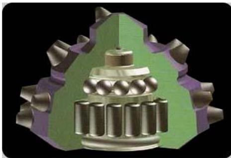
Figura 20 - Rolamento tipo rolete de broca tricônica (BitBrokers)
