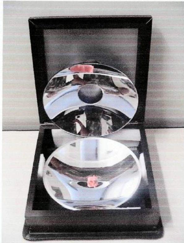
Figura 4.4 – Foto da estrutura da caixa: com os dois espelhos e o objeto (porquinho), posicionado no centro espelho inferior.
