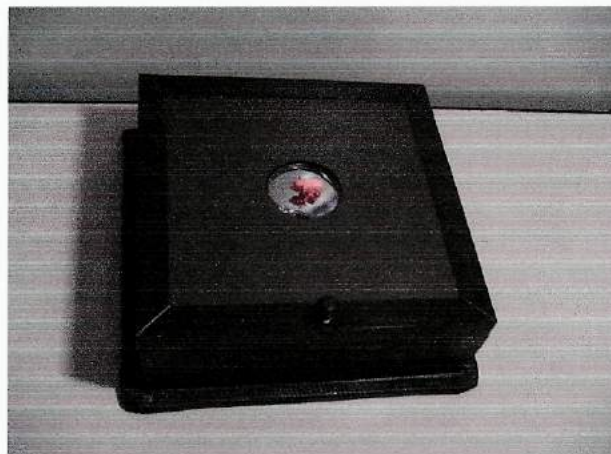
Figura 4.3 – Foto da caixa construída mostrando a imagem real de um porquinho sendo formada na abertura circular da caixa.
