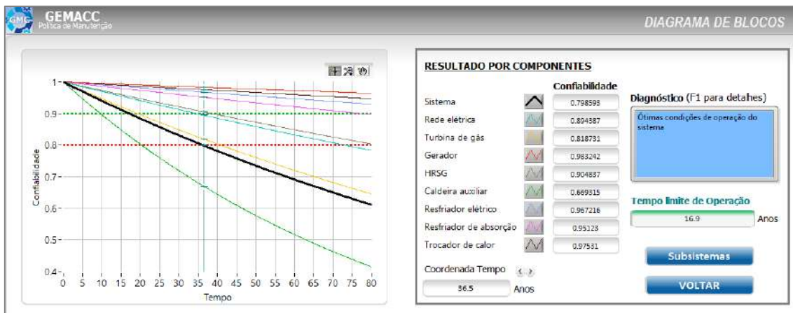
Figura 4.40 – Resultados por componente simulados com distribuição exponencial – BCHP (9 anos)
