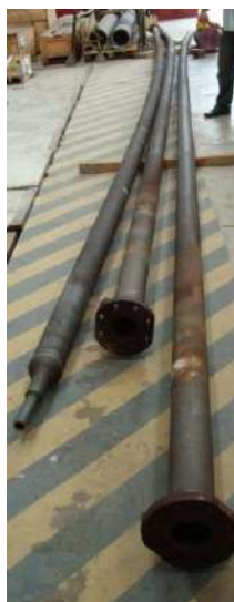
Figura 2.4—Exemplo de tubos de reforma, com 13,4 metros de comprimento, desativados após 114.000 horas de serviço.
