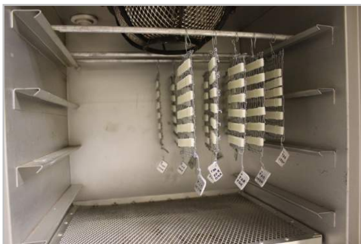
Figura 26: Organização das amostras no interior da estufa durante o envelhecimento térmico.
