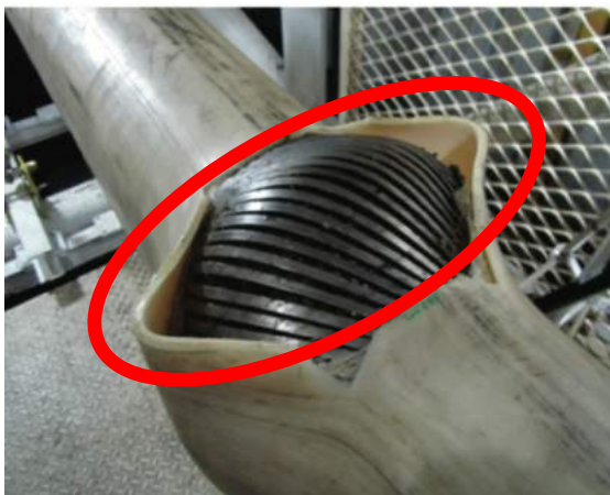
Figura 3: Efeito de abertura dos arames que compõe a armadura de tração. Adaptado de TALGATTI et al. , (2014).
