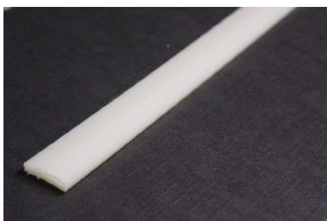
Figura 21: Geometria de uma amostra de PVDF ao ser processado com a matriz retangular.
