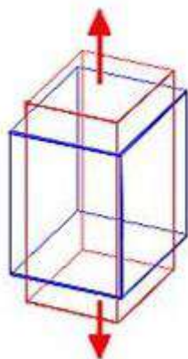
Figura 3 – Exemplo de um objeto (azul) sofrendo uma tração longitudinal, com contração lateral e aumento do comprimento (vermelho).
