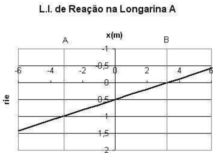
Figura 25 – Coeficientes de distribuição transversal para duas longarinas.
