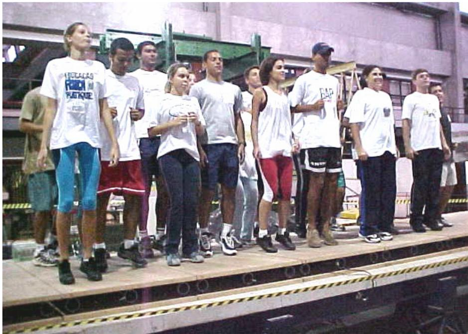
Fig.11 – Ensaio com 20 pessoas pulando sobre a plataforma [1].
