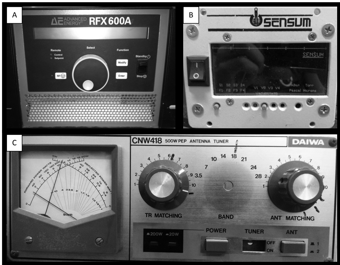
Fig. 6 – Principais equipamentos de controle dos parâmetros do plasma. (a) Fonte de RF; (b) Vacuostato; e (c) Casador de impedância.
