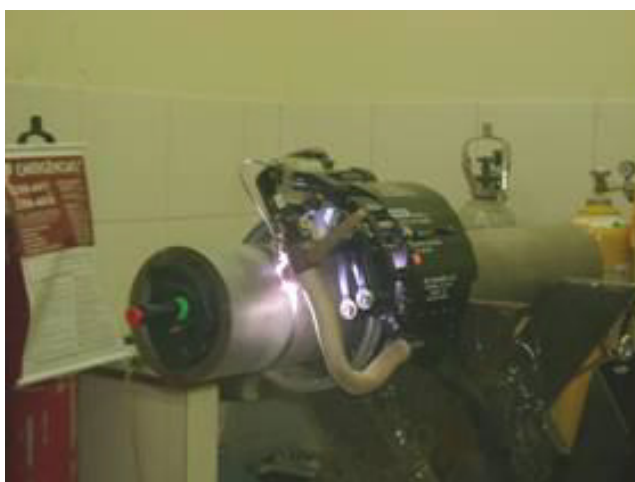
Figura 31 – Soldagem TIG orbital do tubo de superduplex
