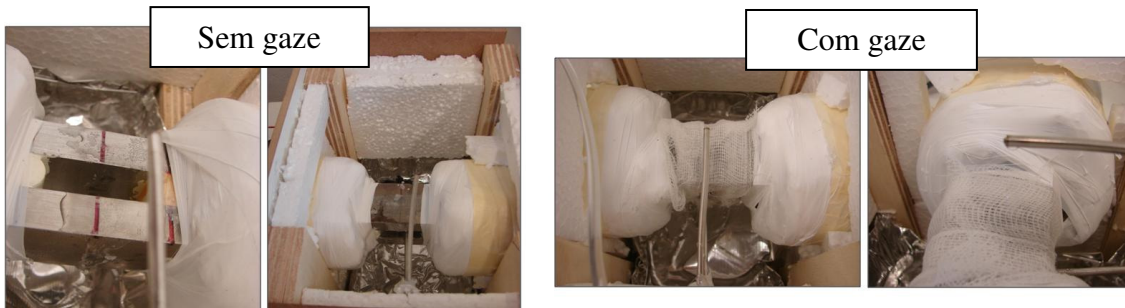
Figura 28 – Teste do sistema para verificação dos parâmetros PID do controlador de temperatura.
