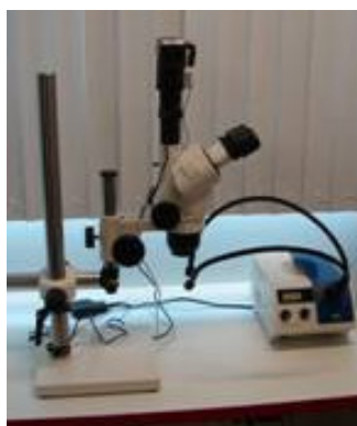
Figura 36 – Estereoscópio ZEISS utilizado na análise superficial dos CP's após os ensaios.
